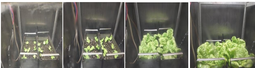
Рисунок 11 - Фото салата «Московский парниковый», выращенного на ППС под светодиодными лампами (серия экспериментов КОНТРОЛЬ)
