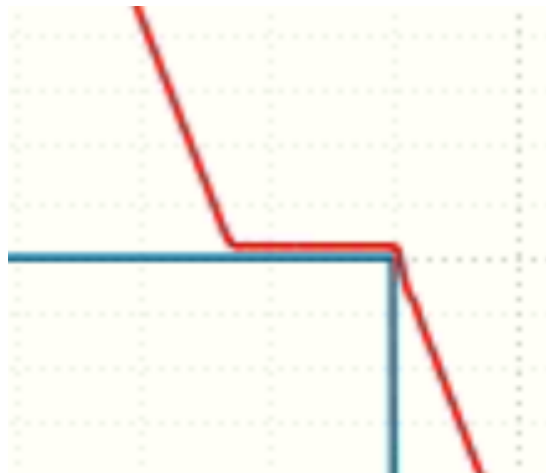
Рисунок 8.3 – Погрешность позиционирования «К» - разница между красной и синей линией.
