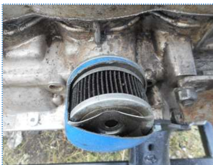
Рис. 7. Фильтр очистки масла двигателя в разрезе
