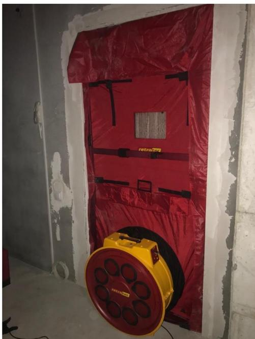
**Рис. 2.2.1 «Аэродверь «Retrotec 5000», установленная в дверной проем»**
