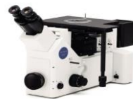
Изучение неметаллических включений образцов ГОСТ 1778-70
