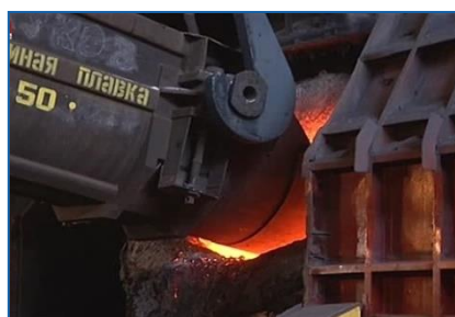
Загрузка лома в конвертер
