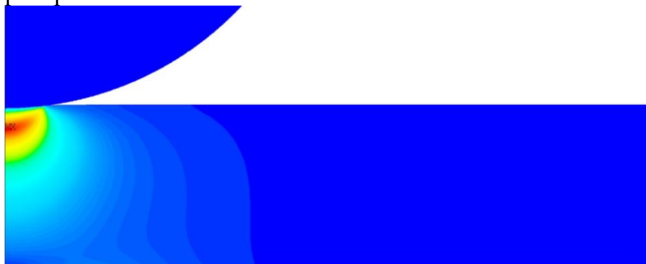
Рис. 3.4.2. Характер распределения интенсивности пластических деформаций
