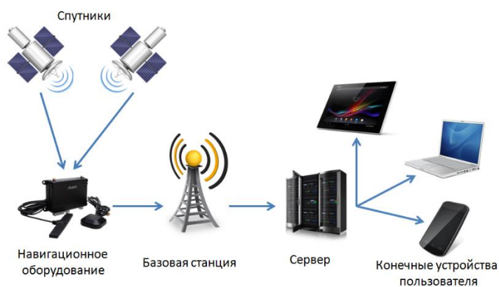
Рисунок 2.3 – Схема работы систем спутникового мониторинга
