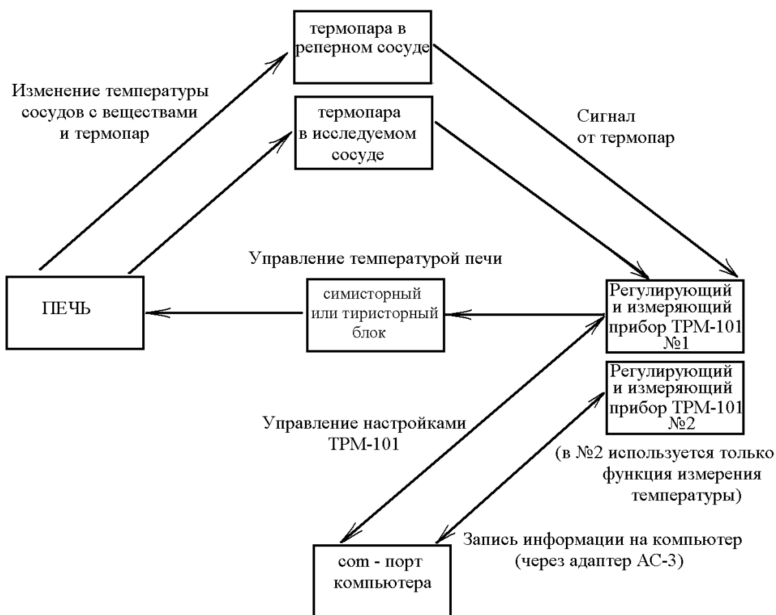
Рис.8. Блок-схема установки для ДТА.
