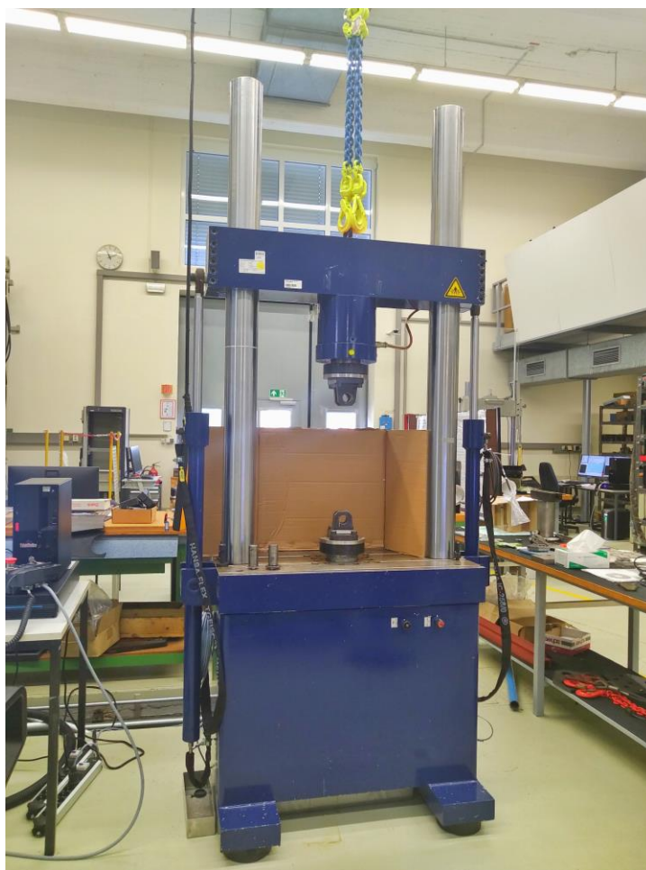
Рисунок 29 – Сервогидравлическая машина Schenck
