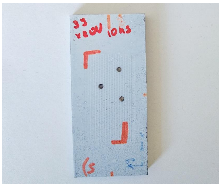
Рисунок 31 – Измерение остаточных напряжений
