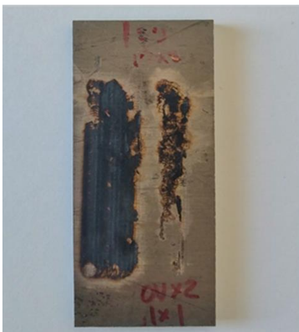
Рисунок 36– Результат лазерной обработки образца при 5 Дж
