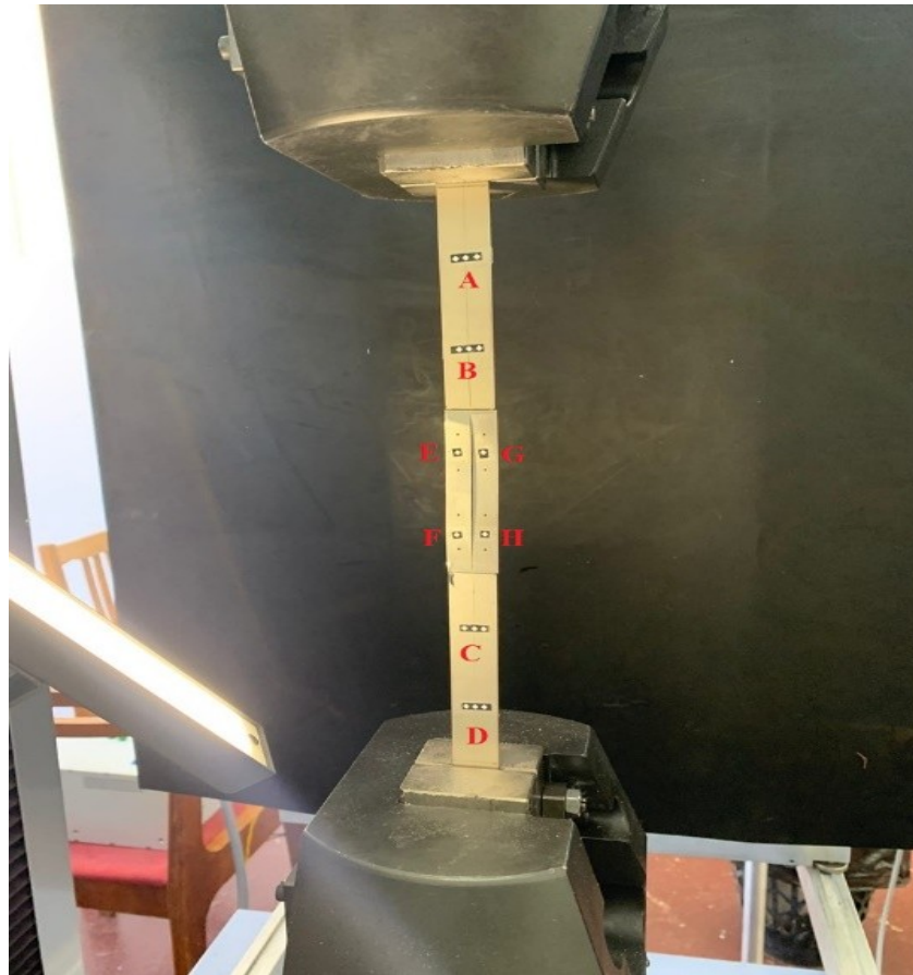
Рисунок 8 -Расположение образца с отметками для видеоэкстензометра
