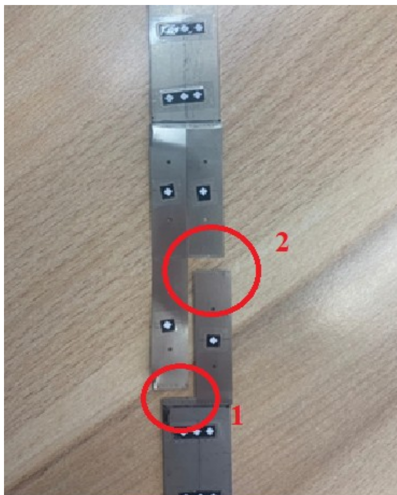
Рисунок 9- места отрыва образца
