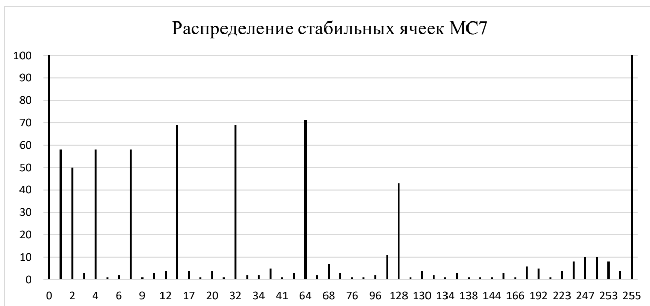
Рисунок 2.13 – Частота повторяемости значений стабильных ячеек микросхемы № 7
