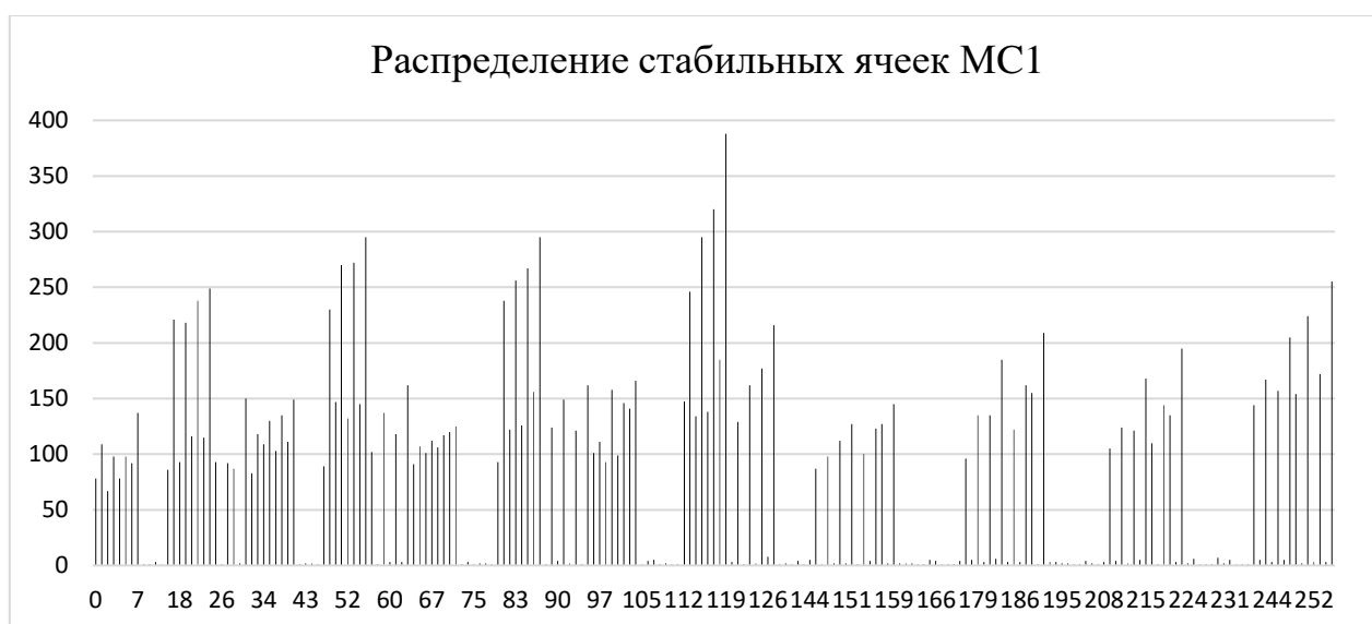
Рисунок 2.7 – Частота повторяемости значений стабильных ячеек микросхемы № 1
