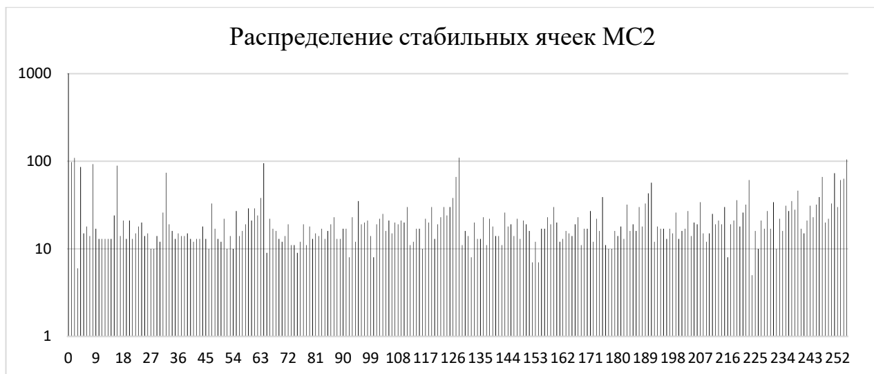
Рисунок 2.8 – Частота повторяемости значений стабильных ячеек микросхемы № 2
