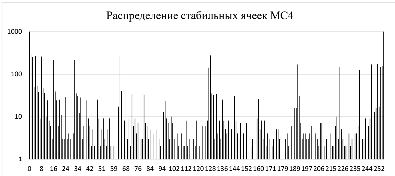
Рисунок 2.10 – Частота повторяемости значений стабильных ячеек микросхемы № 4
