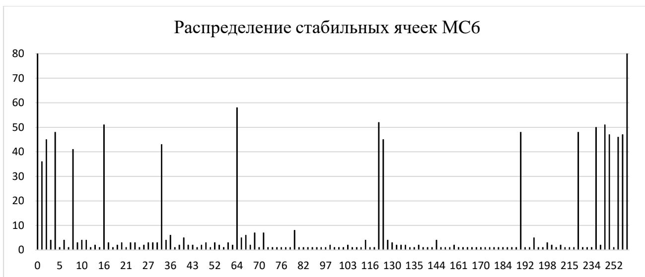
Рисунок 2.12 – Частота повторяемости значений стабильных ячеек микросхемы № 6
