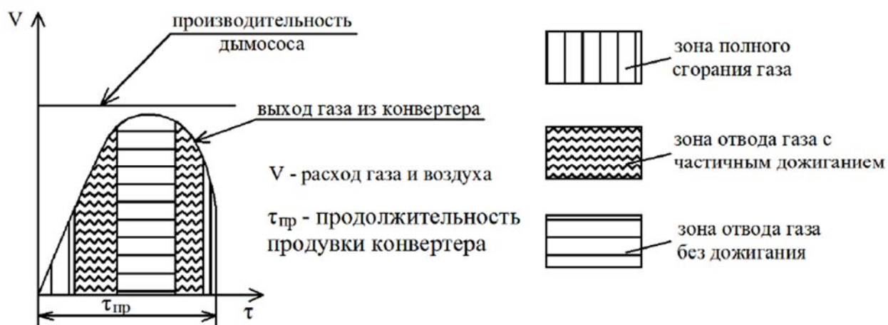
Рис. 1.5 – Схема отвода газа с частичным дожиганием CO
