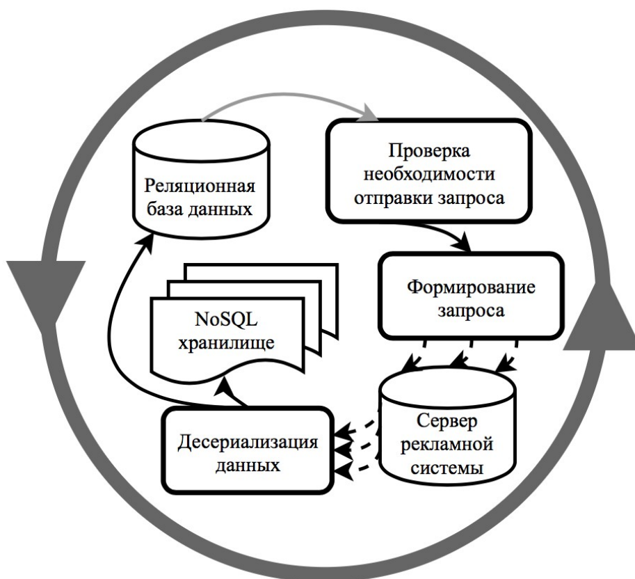
Рисунок 2.2.2. Схема процесса выгрузки данных с сервера рекламной системы
