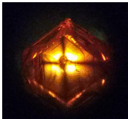
Рисунок 5. Фотография \text{CH}_3\text{NH}_3\text{PbBr}_3 между скрещенных поляризаторов оптического микроскопа. Отчетливо наблюдается коноскопический крест.
