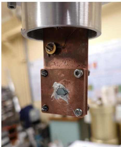
Рисунок 8. Фотография с образцом на подложке на медном пальце криостата.
