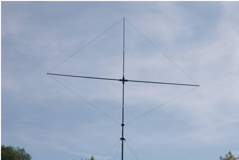
Рисунок 1.1. Элемент антенной решетки с немеханическим движением луча в виде ромбической антенны
