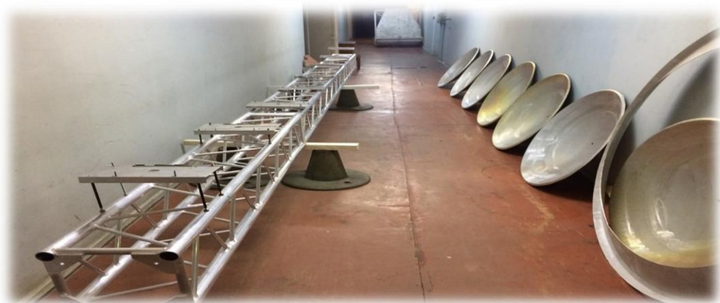
Рисунок 3.8. Опорная ферма с установочными фланцами
