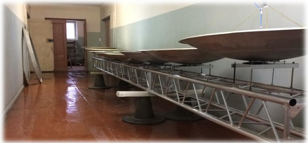
Рисунок 3.11. Размещение зеркал на опорной ферме
