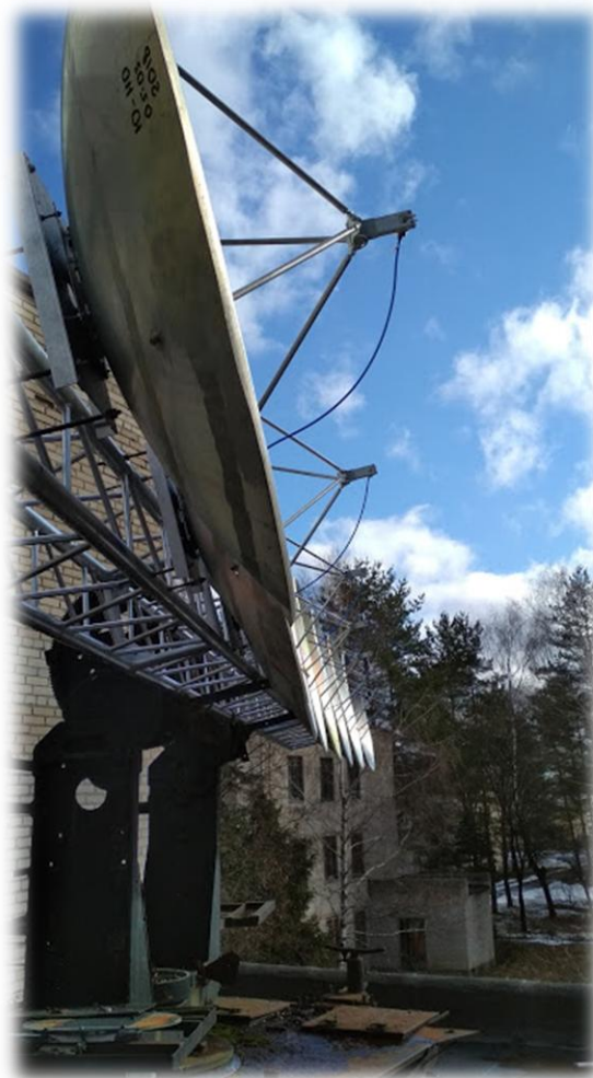
Рисунок 3.12. Вид на антенную решетку, установленную на экспериментальный стенд.
