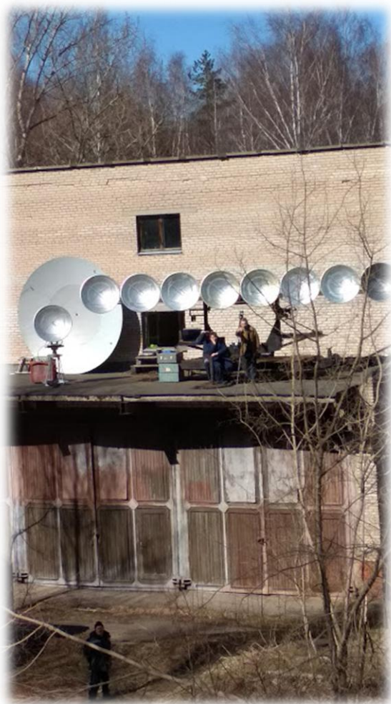
Рисунок 3.12. Вид на антенную решетку, установленную на экспериментальный стенд.
