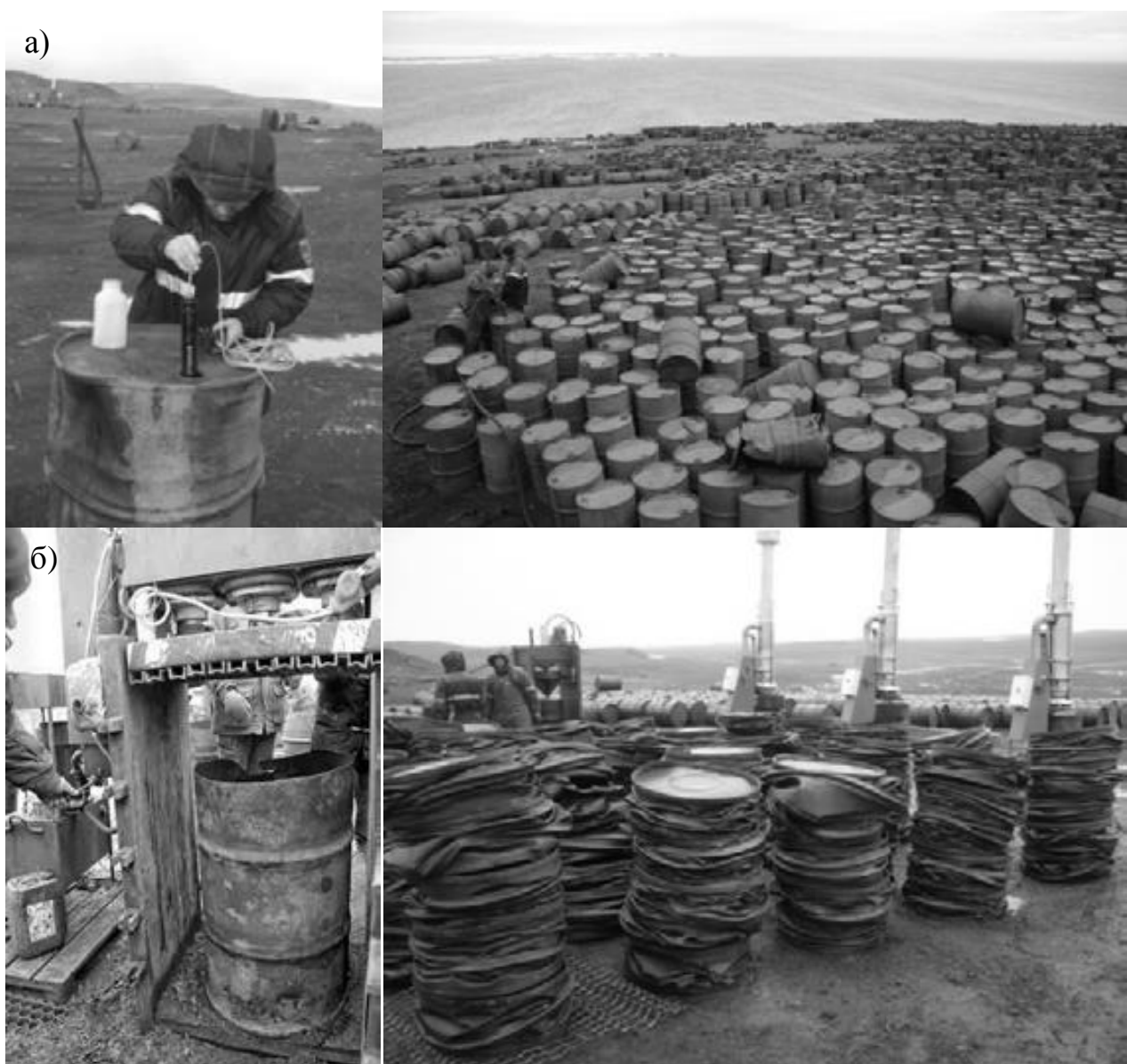
Рисунок 18 – Процесс подготовки к вывозу использованной бочкотары: а – сбор нефтепродуктов из бочек; б – прессование металлических отходов
