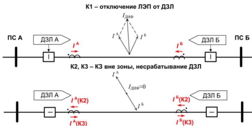
Рисунок 3.2. Принцип действия ДЗЛ
