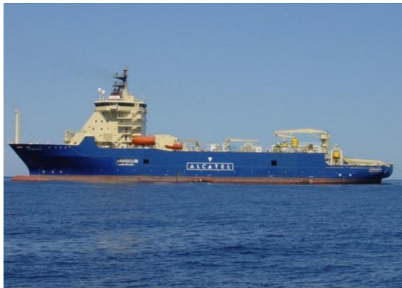
Pe de Batz, Франция, Alcatel-Lucent Submarine Networks Ltd., грузопместимость 5500 тонн кабеля [4,5]
