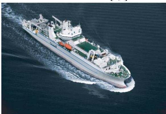
Dependable, США, Tyco Electronics Subsea Communications LLC, грузопместимость 5446 тонн кабеля [4,7]
