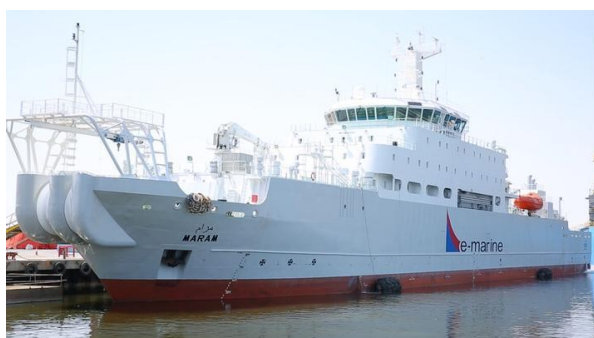
CS Maram, ОАЭ, E-Marine PJSC, грузопместимость 2750 тонн кабеля [4,9]
