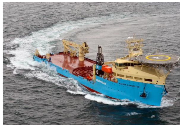
Maersk Connector, Германия, Maersk Supply Service, грузопместимость 7000 тонн кабеля [10]
