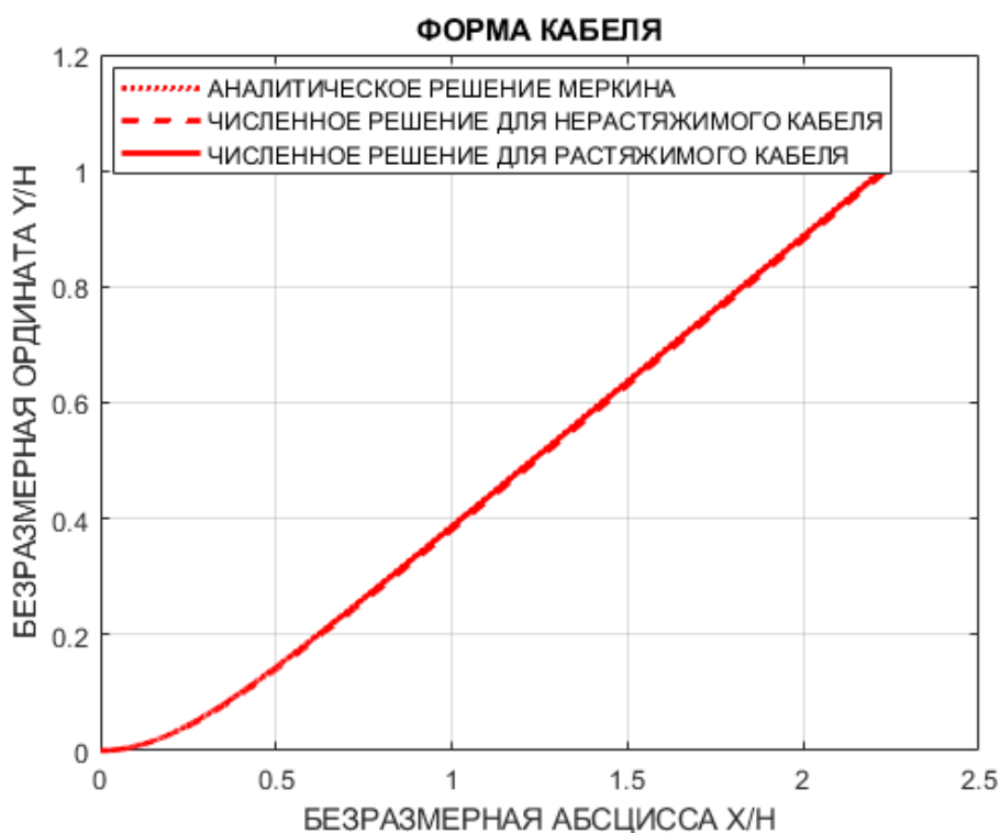
Рис. 3.4 Сравнение методов решения для малых нелинейных характеристик на примере формы провисающего участка кабеля (при V = 3 узла)
