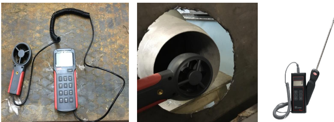
Рис. 6. Измерение скорости ветра термоанемометром
