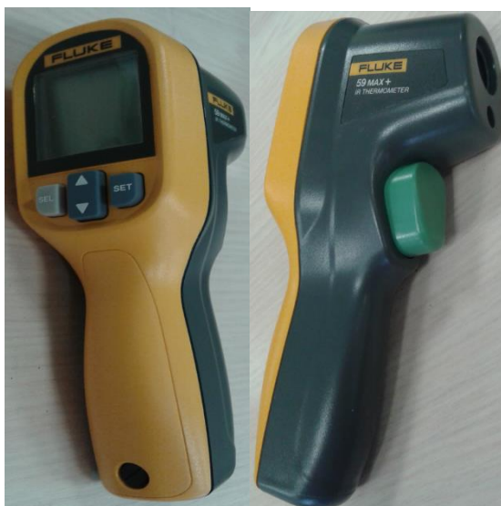
Рис. 7. Измерение тепловых полей пирометром «Fluke»
