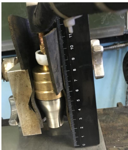
Рис. 4. Выполнение наплавки при различных углах наклона горелки
