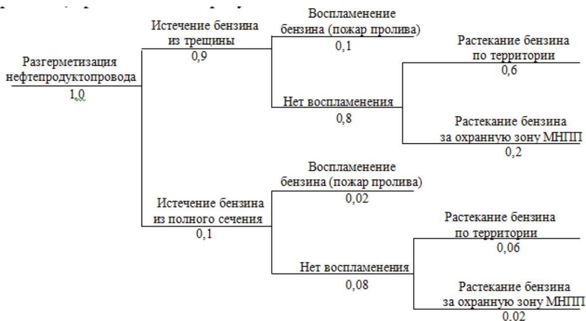
Рисунок 3.2 – Дерево событий, при разгерметизации нефтепродуктопровода
