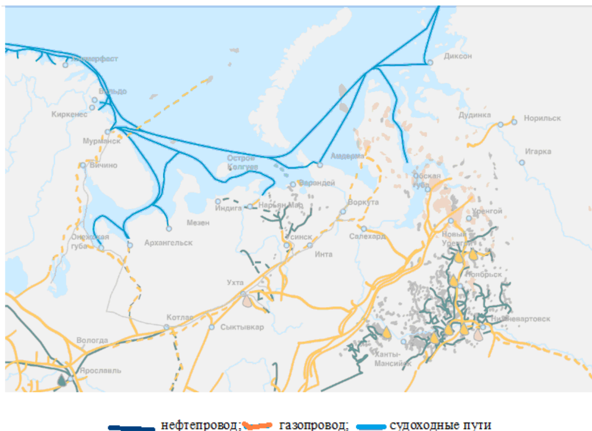
Рисунок 1.1 – Карта - схема системы транспортировки нефти и газа в российской Арктике (по данным рабочей группы Арктического совета по реализации программы арктического мониторинга и оценки (АМАР)).
