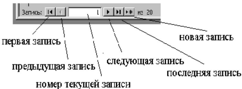
Рис. 13. Поле номера записи
