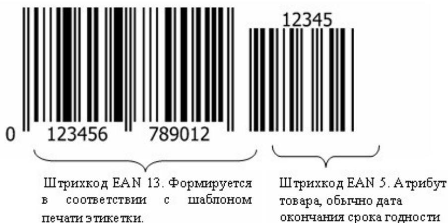
Рисунок 3.3.3 - Структура «Умного» штрихового кода типа 13+5
