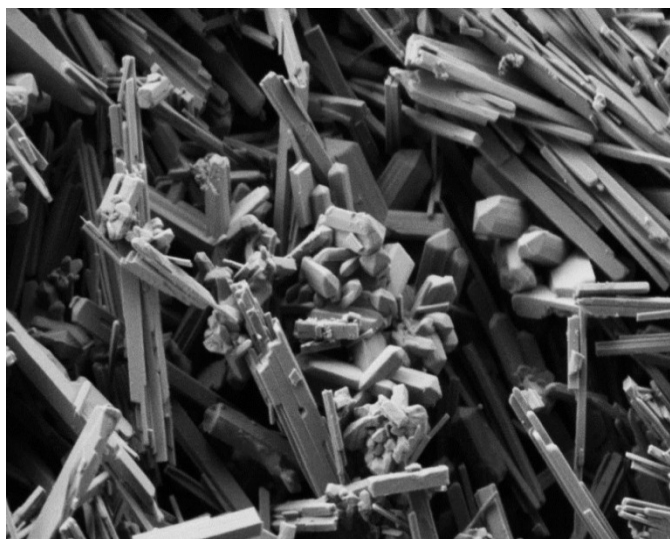
Рис. 42. Микроструктура диоксида ванадия, полученного гидротермальной обработкой фазы (\text{NH}_4)_{0,22}\text{V}_2\text{O}_5 при 210^\circ\text{C} в течение 24 ч.
