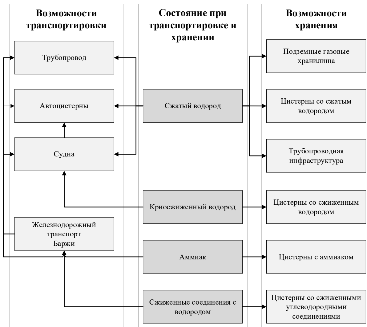
Рисунок 3.3 – Основные способы транспортировки и хранения водорода
