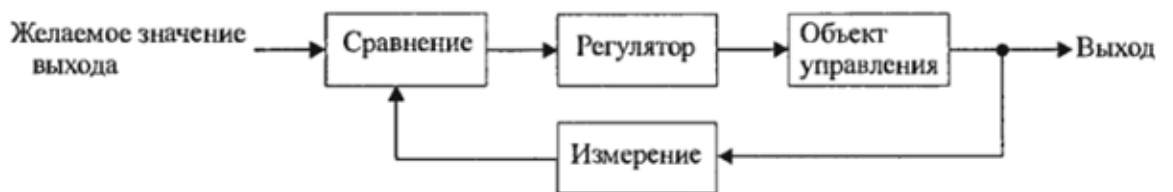
Рис.1.4. Замкнутая система управления (с обратной связью)
