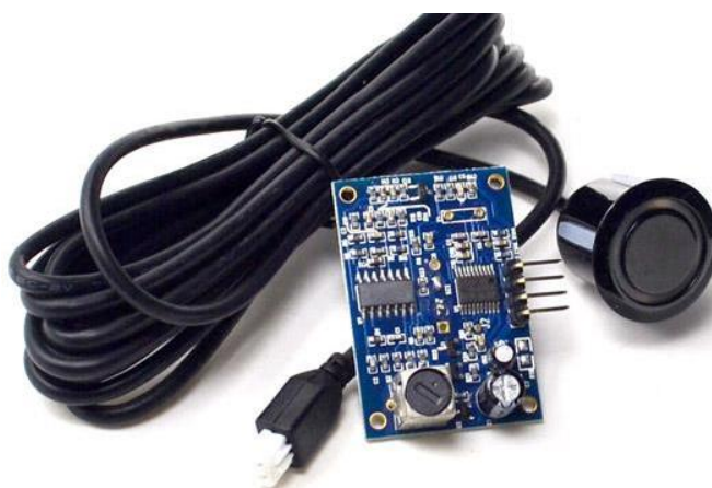
Рисунок 2.22 – JSN–SR04T УЗ датчик расстояния с платой–преобразователем
