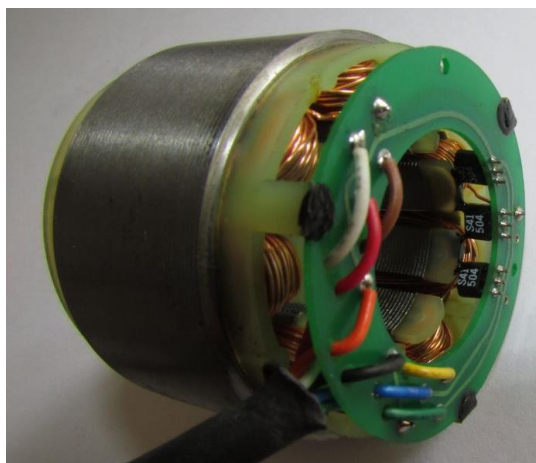
Рисунок 2.8 – БДПТ с датчиками Холла
