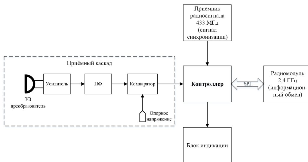
Рисунок 2.25 – Структурная схема маяка
