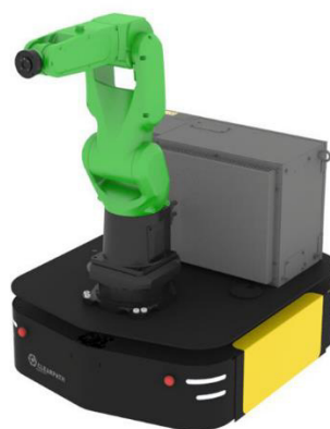
Рисунок 1.5 – Платформа RIDGEBACK, оснащенная манипулятором Fanuc
