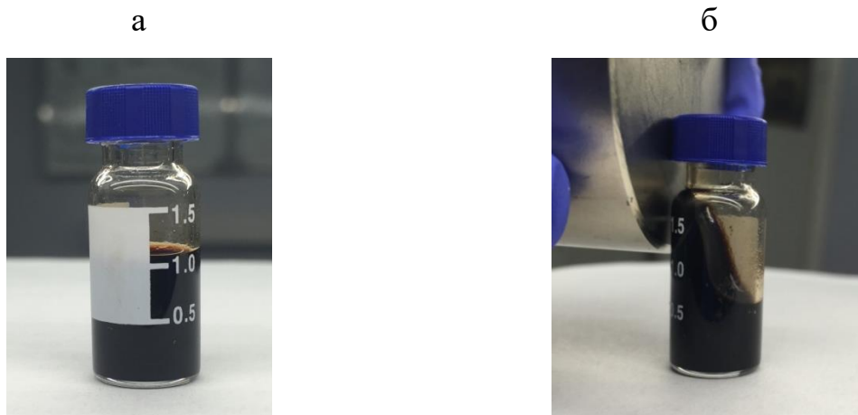
Рисунок 27– Магнитные наночастицы Fe_3O_4 : а) без внешнего магнитного поля, б) в постоянном внешнем магнитном поле
