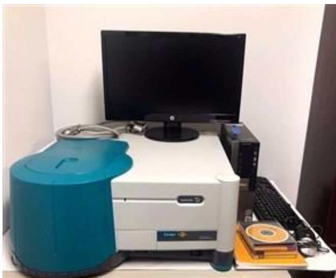
Рисунок 3.2 – Спектрофлуориметр CaryEclipse (Varian)
