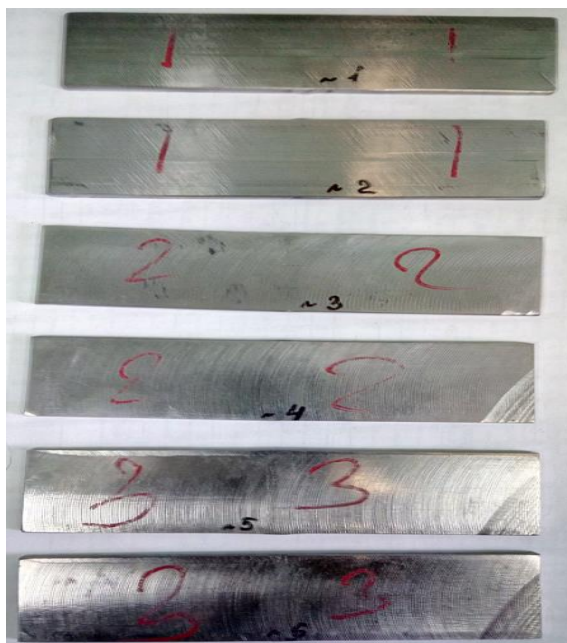
Рисунок 2.29 – Внешний вид образцов из сплава ВТ20 для проведения радиографического контроля ( \delta = 3 мм)
