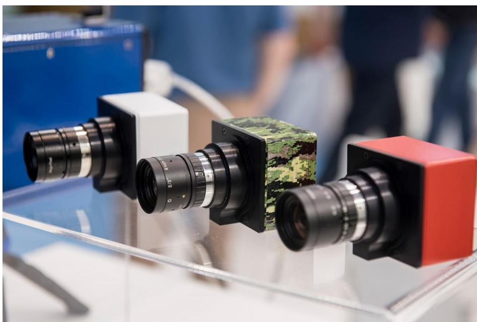
Рисунок 3.6 - Мини камера для квадрокоптера позволяющая вести съемки в ИК диапазоне
