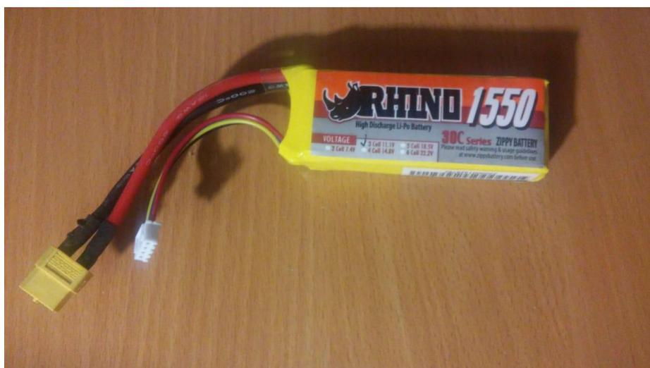
Рисунок 6.3 - Батарея для питания квадрокоптера и подвеса камеры
