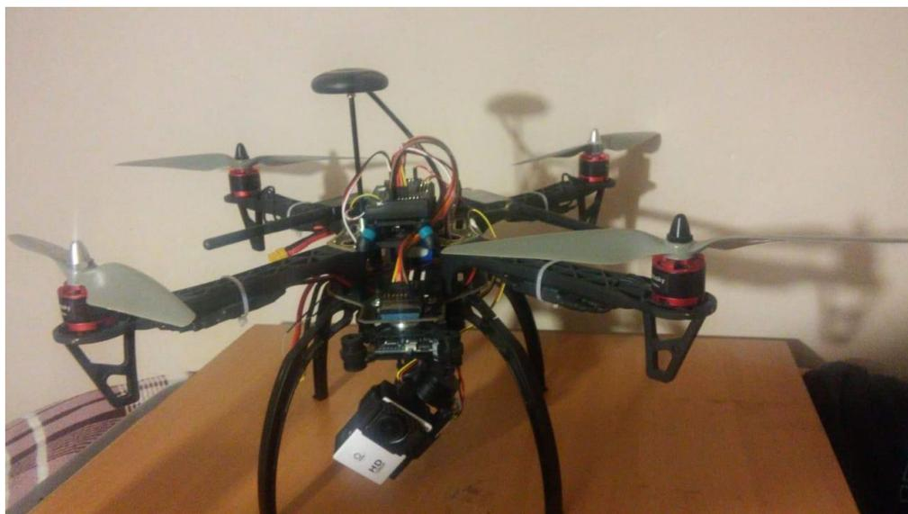
Рисунок 6.1 - Внешний вид разработанного квадрокоптера
