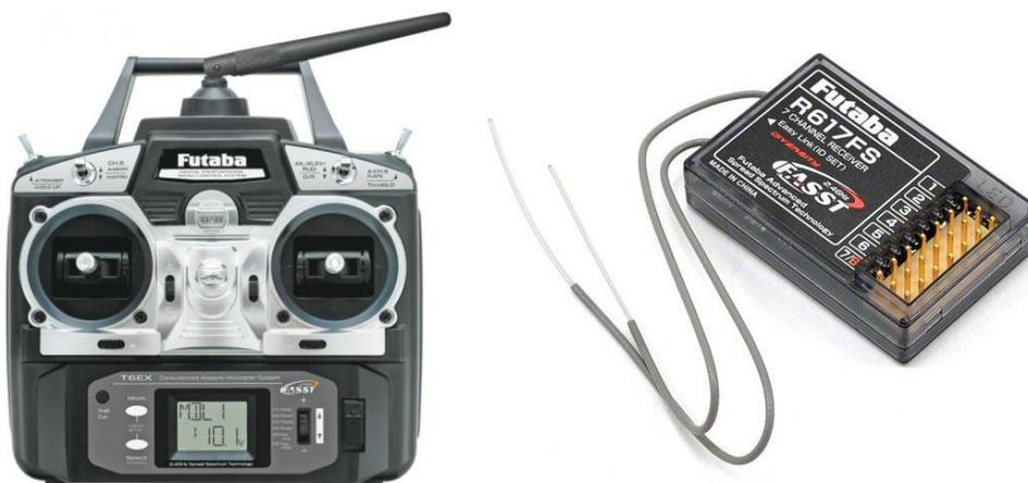
Рисунок 1.7 - Приемник и передатчик радиосигнала для управления моделью
