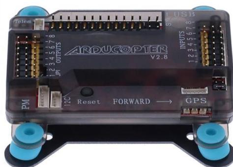
Рисунок 1.3 - Полетный контроллер, установленный на плату виброразвязки
