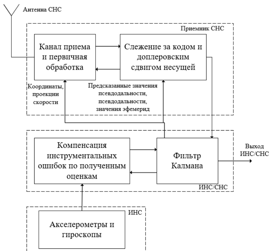
Рисунок 11 – Жестко связанная схема комплексирования ИНС и приемника ГНСС
