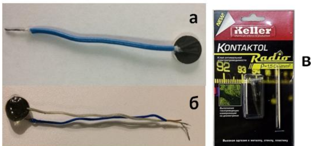
а – с нанесенным на поверхность графитовым контактолом; б – в эпоксидной смоле; в – контактол графитовый
