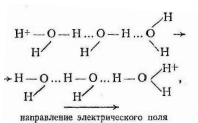
Рисунок 9 – Схема движения протона вдоль линии водородной связи[30]
