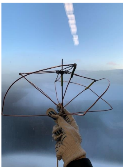
Рисунок 4.2.3 – Процесс изготовления клеверной антенны с емкостной нагрузкой
