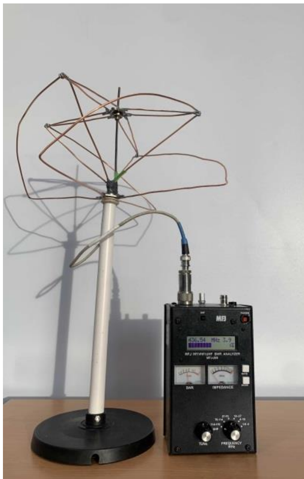
Рисунок 4.1.1 – Собранный макет антенны с емкостной нагрузкой и подтверждающими показателями работоспособности на приборе MFJ-269
