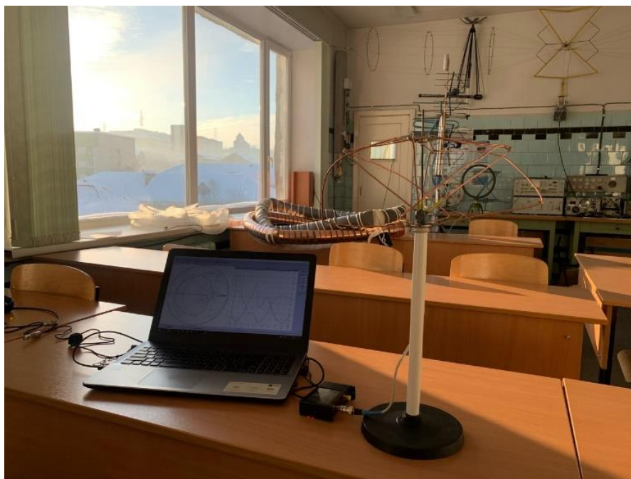
Рисунок 4.1.2 – Проверка работоспособности макета на базе анализатора спектра Simple Vector Network Analyzer
