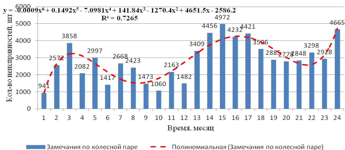
Рисунок 2.8 – Динамический временной ряд по числу неисправностей колесных пар и аппроксимирующая кривая
