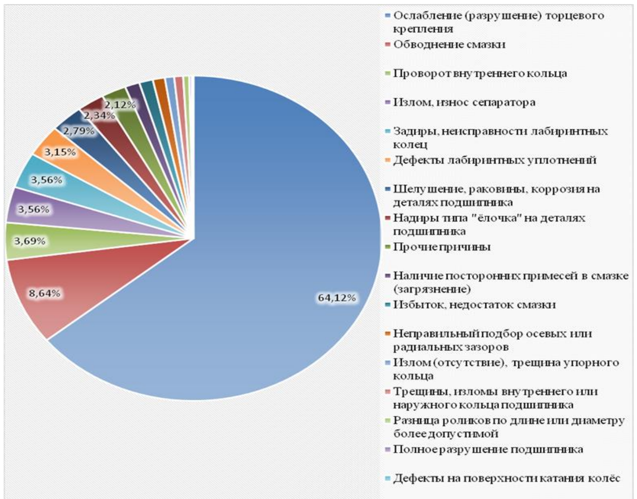
Рисунок 2.10 – Диаграмма основных неисправностей буксовых узлов
