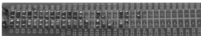
Рисунок 1.2. Конструкция ЭФИ на основе RC-элементов для аппроксимирующей функции импеданса 20-го порядка
