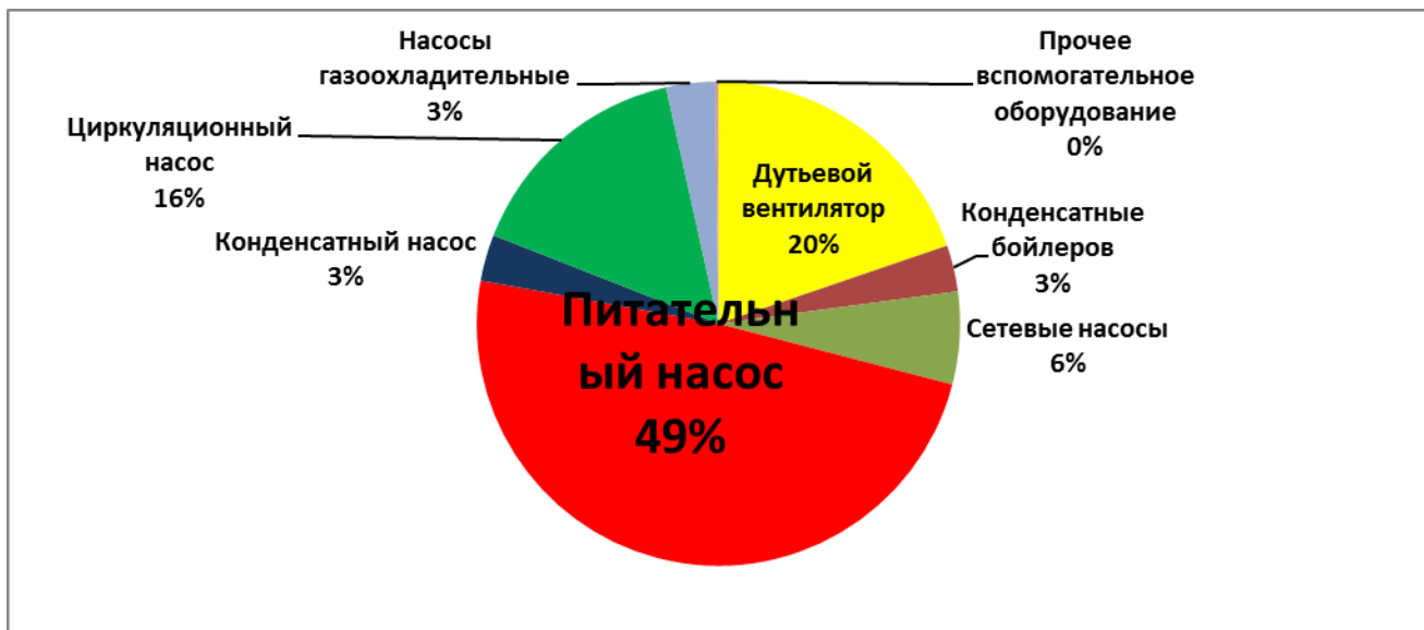
Рисунок 2.4 - Потребление электрической энергии на собственные нужды
