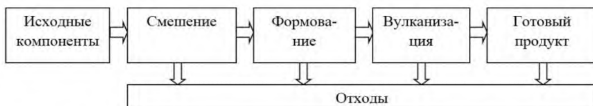
Рисунок 1.1– Принципиальная схема получения эластомерных изделий по технологиям резинового производства
