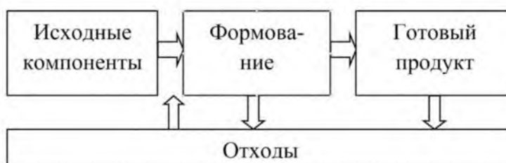
Рисунок 1.2 – Принципиальная схема получения изделий из термоэластопластов
