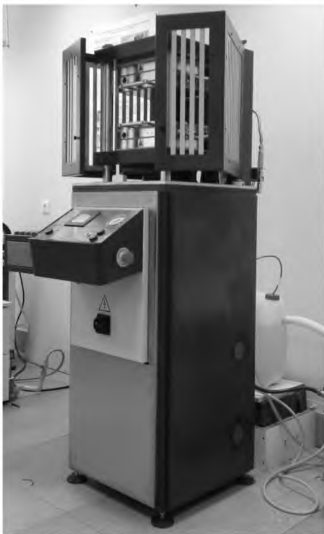
Рисунок 3.3 – Внешний вид лабораторного гидравлического пресса фирмы «Gibitre» (Италия), снабженного системами нагрева и охлаждения плит
