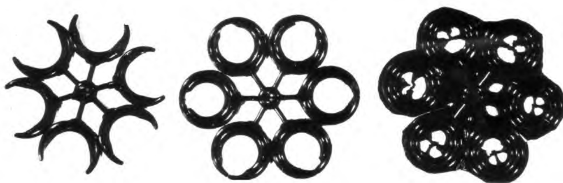
Рисунок 2.5 – Последовательность заполнения формы с кольцевой литниковой системой резиновой смесью
