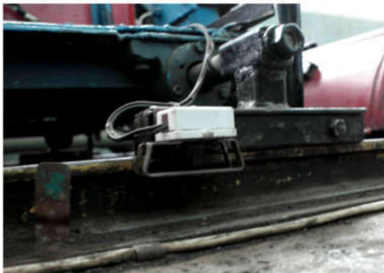
Рисунок 3.2 – Пассивный стабилизатор устойчивости хода подвижного модуля
