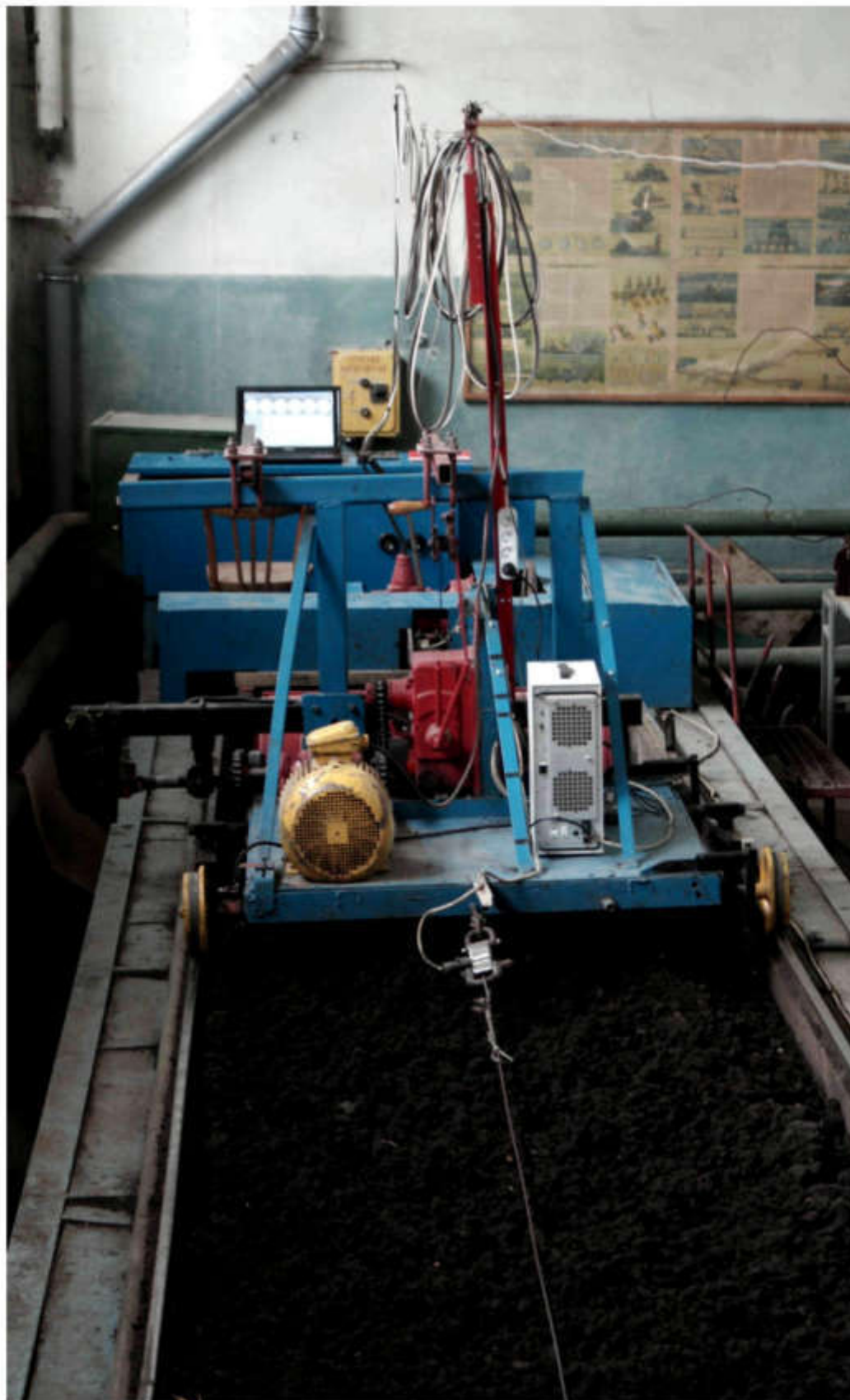
Рисунок 1.5 – Общий вид экспериментального стенда с подвижным модулем для исследования АРО почвообрабатывающих машин
