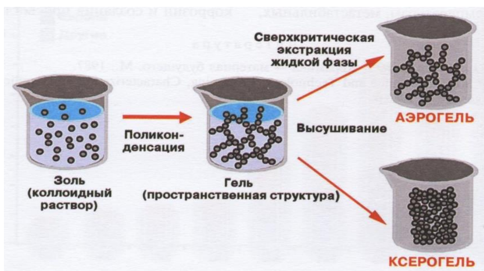
Рисунок 2 – Схема золь-гель процесса
