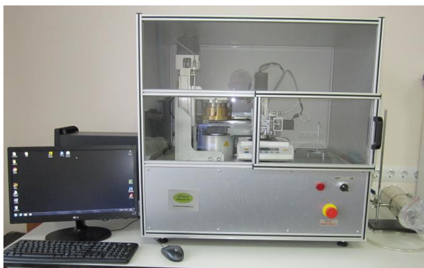
Рисунок 6 – Внешний вид поромера Standard Porosimeter 3.2
