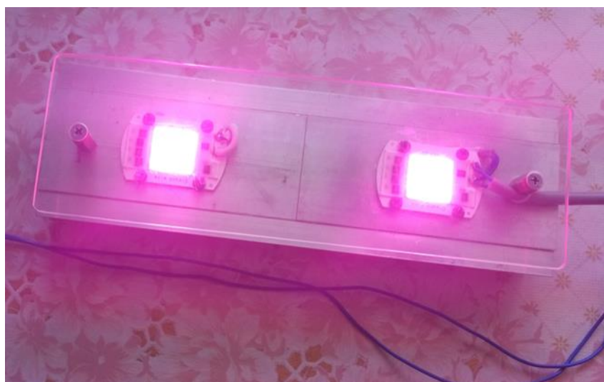
Рисунок 3.21 — Осветительный прибор при включении на минимальную мощность
