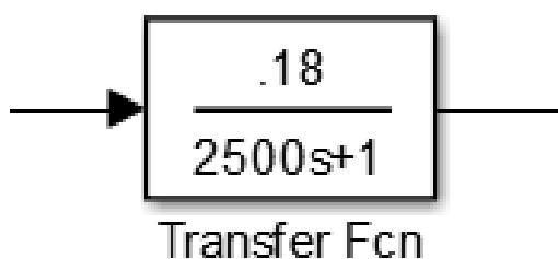
Рисунок 3.5 — Передаточная функция температуры
