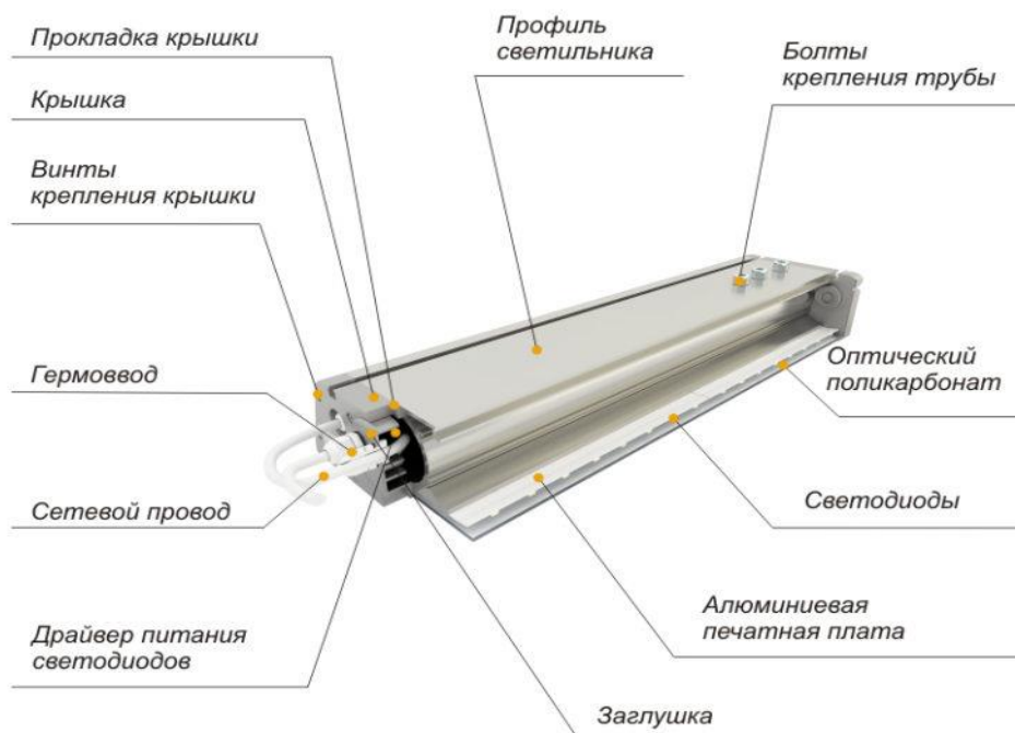
Рисунок 2.4 — Устройство светодиодного светильника
