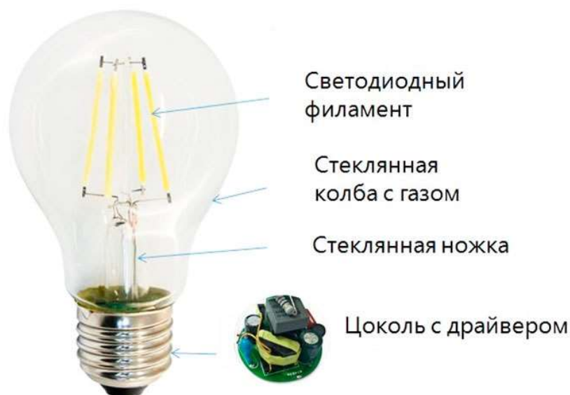
Рисунок 6 – Конструкция светодиодной филаментной лампы
