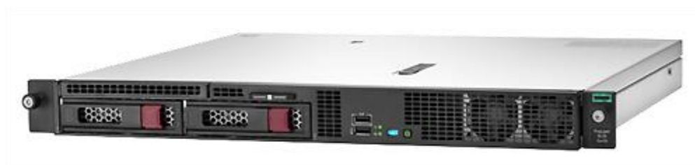
Рисунок 13 – Сервер HPE ProLiant dl20 Gen10 (1U)
