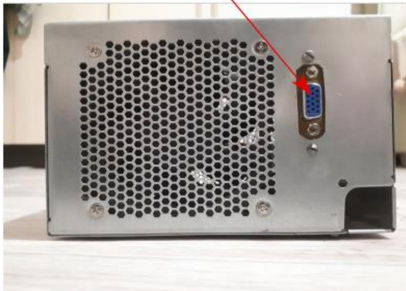
Рисунок 2.18 –Разъём для подключения RGB – ленты в блоке усиления
