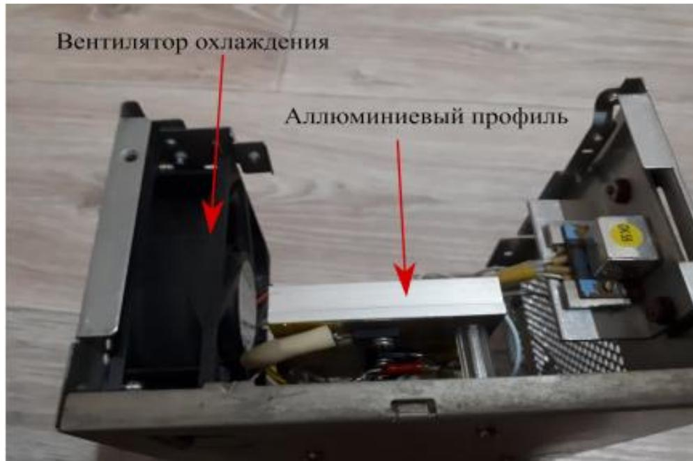
Рисунок 2.20 –Охлаждение блока усиления
