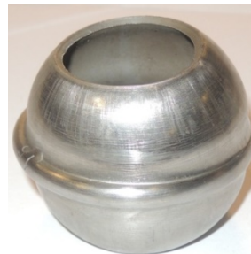
Рисунок 18 – Образование ромбовидной (а) и кольцевой (б) складок при обжиге сферической пробки
