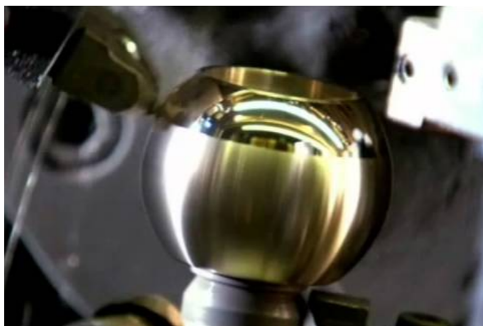
Рисунок 16 – Чистовая обточка шаровой пробки
