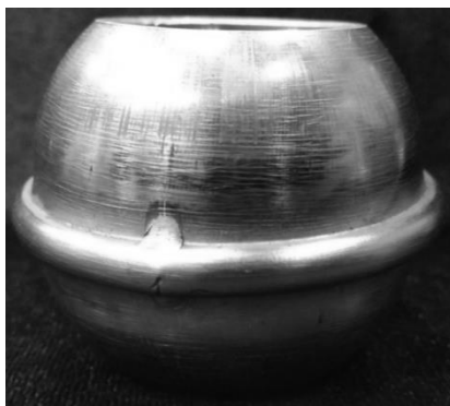
Рисунок 68 – Образование складки на заготовке DN32
