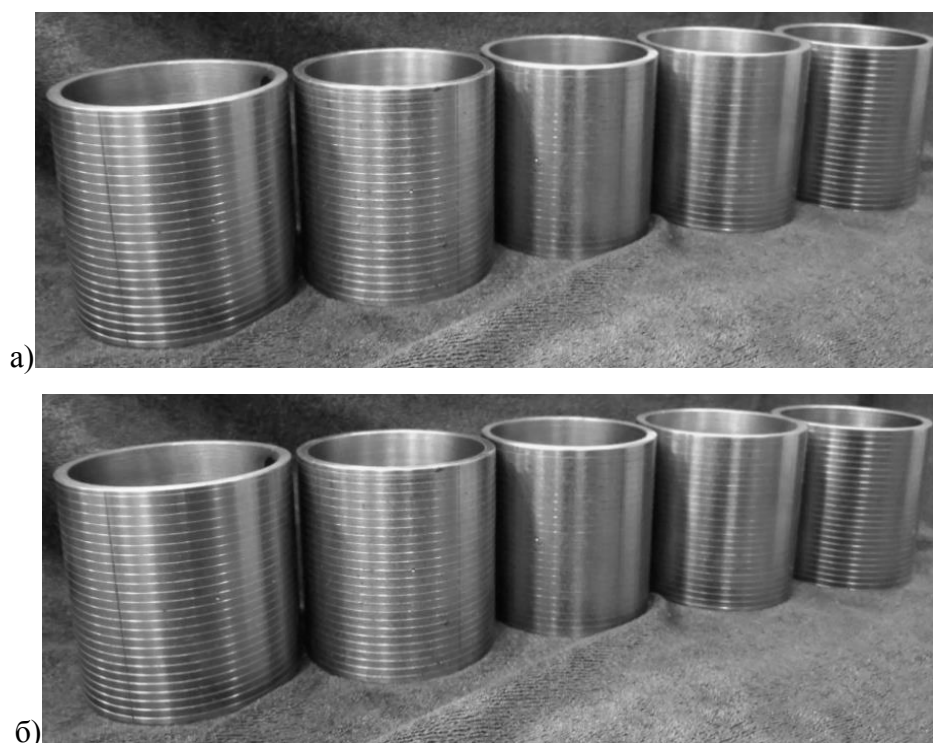
Рисунок 51 – Трубные заготовки для изготовления пробок DN100 (а) и DN32 (б)
