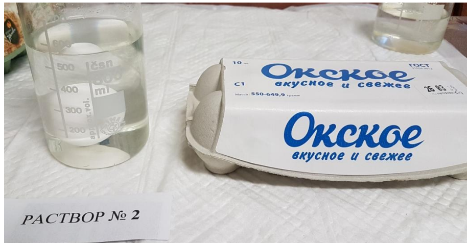
Рисунок 14 - Погружение яиц в раствор № 2 для определения возраста яиц торговой марки «Окское (вкусное и свежее)»
