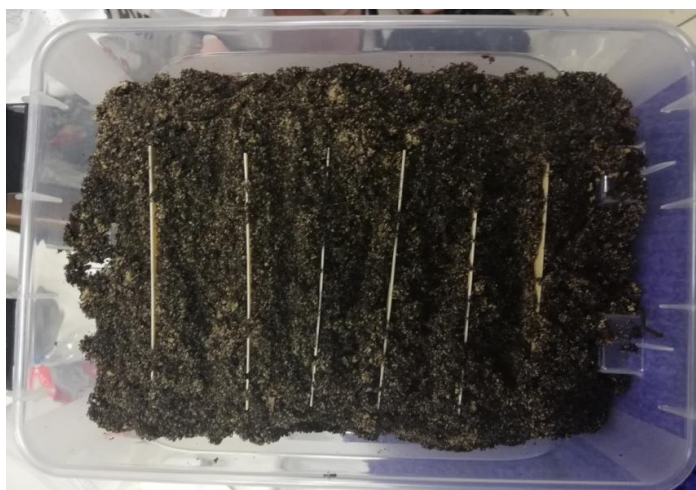
Рисунок 3.8 – Схема размещения компостируемых образцов
