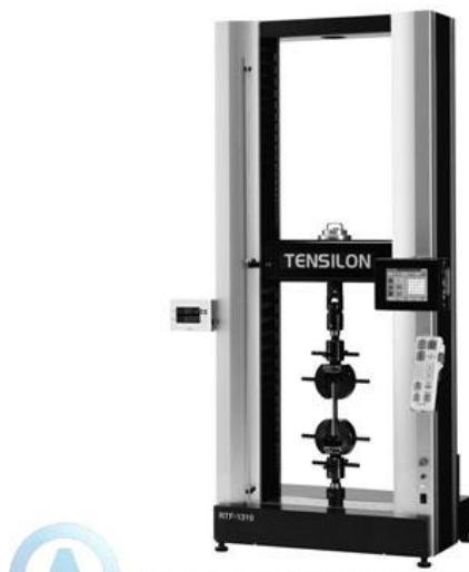
Рисунок 3.5 - Универсальная испытательная машина RTF 1310
