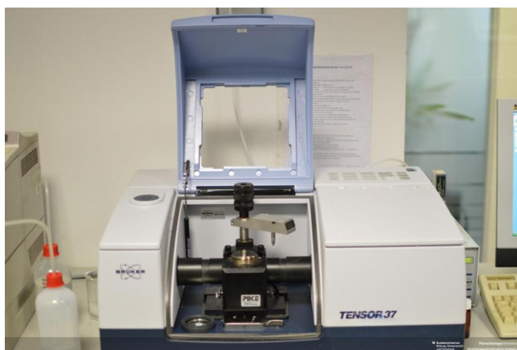
Рисунок 3.4 - Инфракрасный Фурье спектрометр фирмы Bruker с приставкой НПВО от фирмы PIKE
