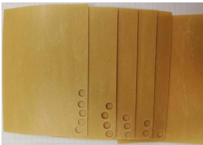
Рисунок 3.9 – Принцип обозначения времени компостирования пленок
