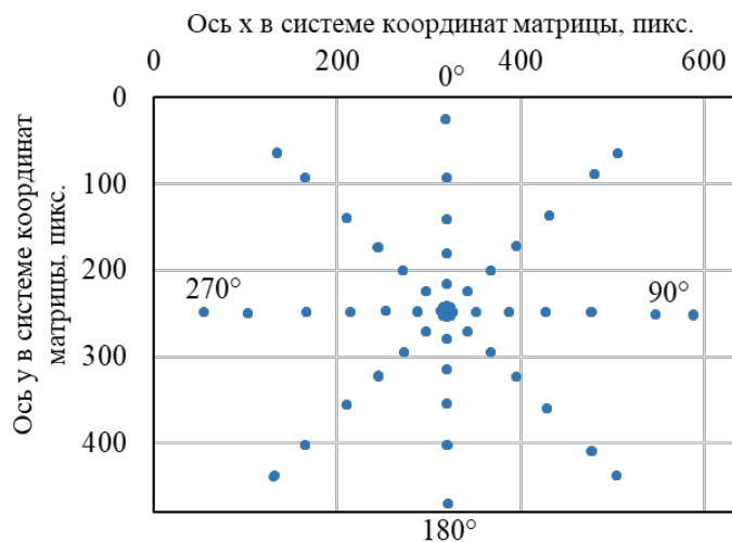
Рис. 4.4. Положение солнечного изображения на КМОП-матрице при калибровке датчика.
