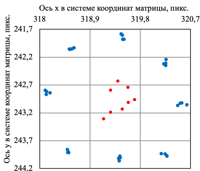
Рис. 4.12. Положение солнечного изображения на КМОП-матрице при параллельности плоскостей датчика и имитатора Солнца (синие точки) и при компенсации поворотом непараллельности плоскости датчика и плоскости матрицы (красные точки).
