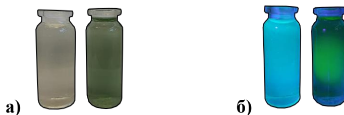
Рисунок 26 - Соединение 1 и 1+KBr в ДМСО до УФ излучения (а) и после (б)
